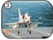
Kuyruğuna takılan kanca ile gemisine iniş yapan bir uçak
